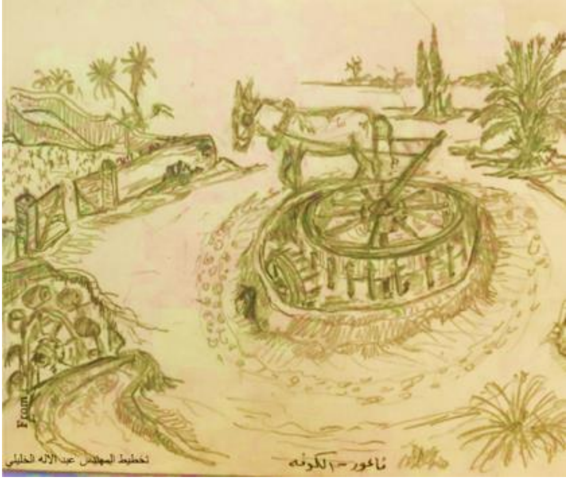
صورة تخطيطية مفصلة للناعور بريشة المهندس عبد الاله الخليلي
