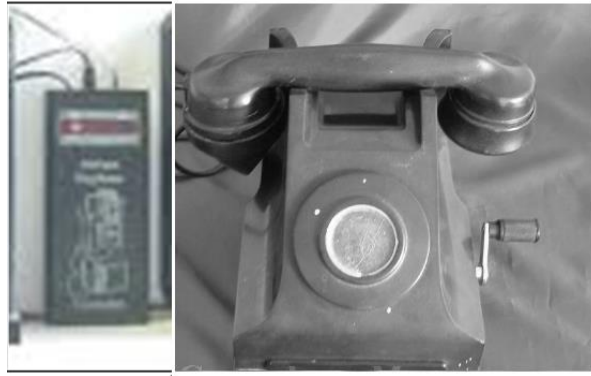
الهاتف بمقبضه الجانبي والبطارية التي تجهزه بالطاقة الكهربائية
